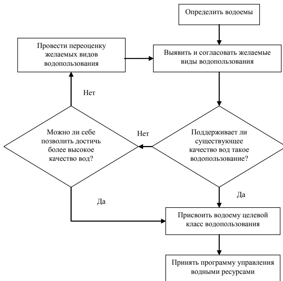
Рисунок 1. Пример итеративного процесса планирования качества вод
